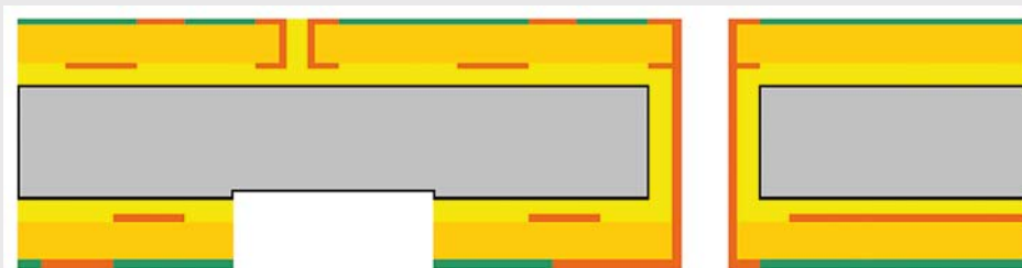
Fig. 5 - Pcb IMS (substrato metallico integrato su 4 layer - fori ciechi - fresatura controllata in Z)
